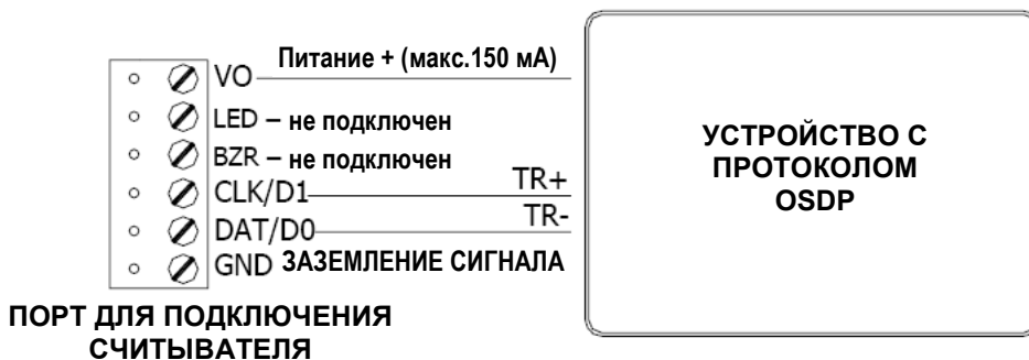
Подключение считывателей с протоколом OSDP
