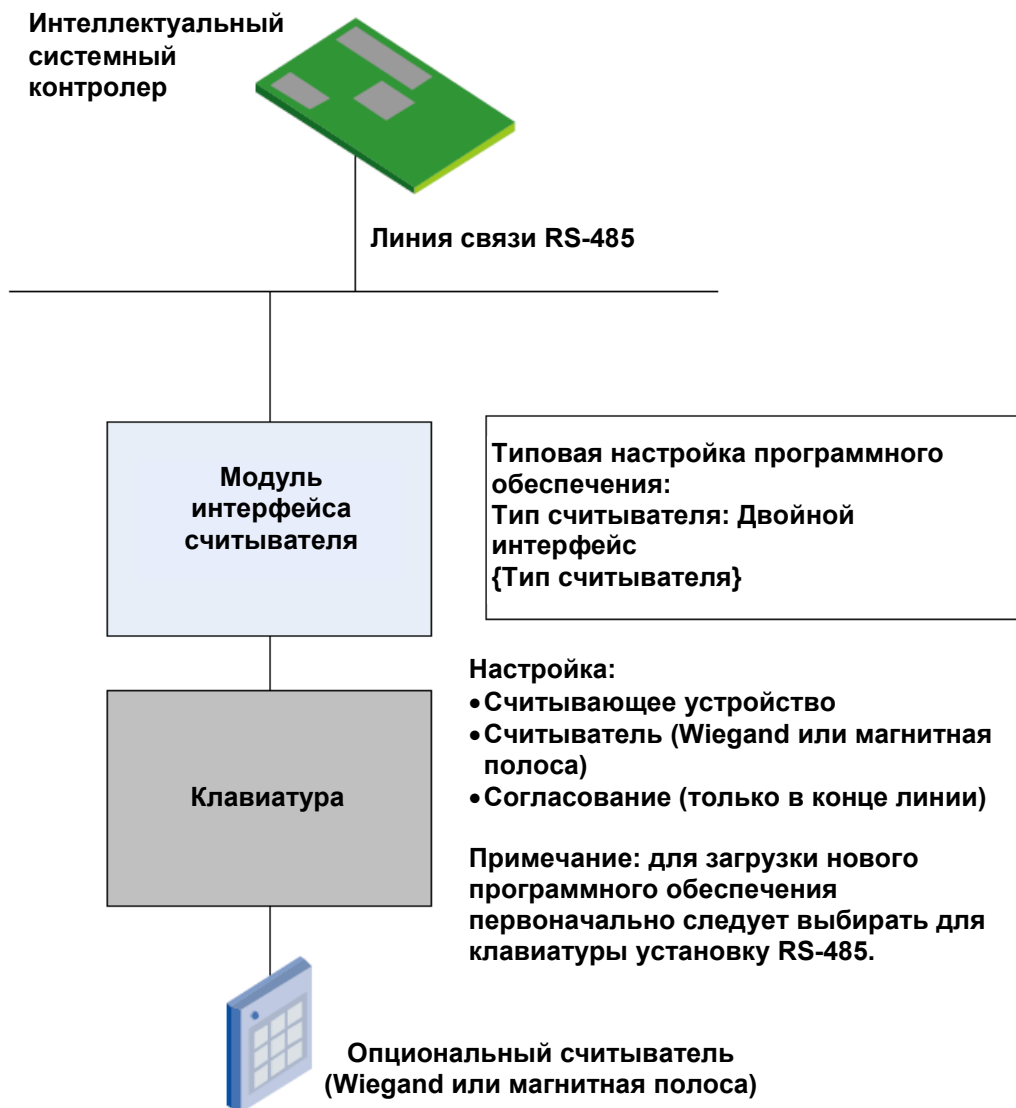
Клавиатура, используемая как считывающее устройство
