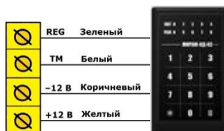
Рис. 7.13. Схема подключения кодовой панели Мираж-КД
