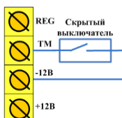
Рис. 7.14. Схема подключения скрытого выключателя
