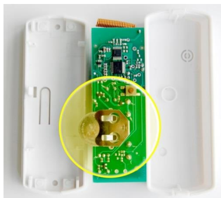
Рис. 7.5. Установка резервного элемента питания в радиоизвещатель Ладoga-МК-РК
