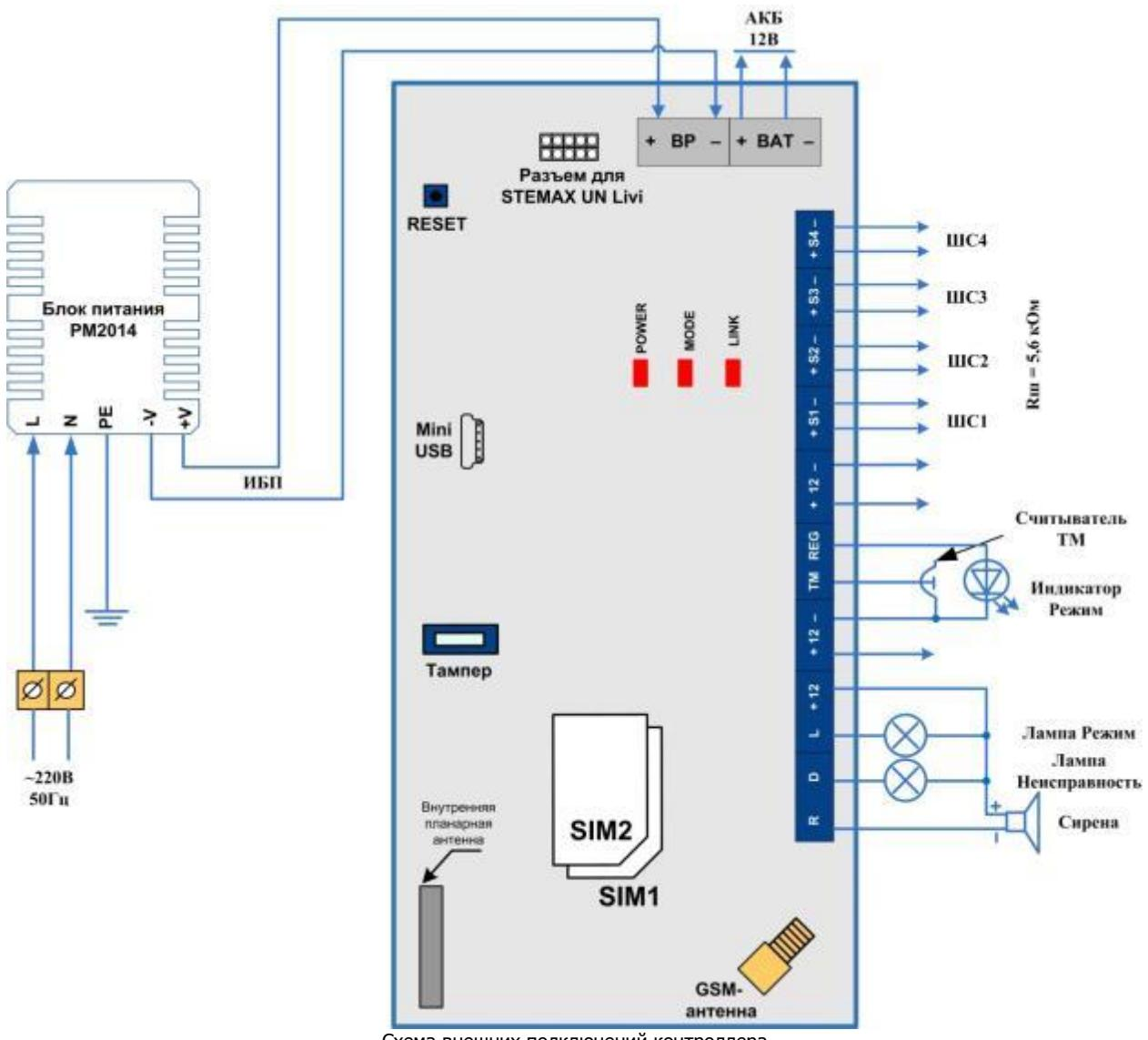
Схема внешних подключений контроллера
