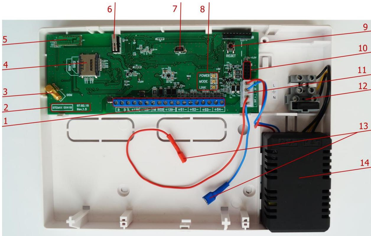
Вид контроллера со снятой крышкой
