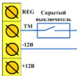
Рис. 4.4. Схема подключения скрытого выключателя
