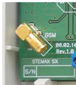
Рис. 4.3. SMA-разъем для подключения GSM-антенны
