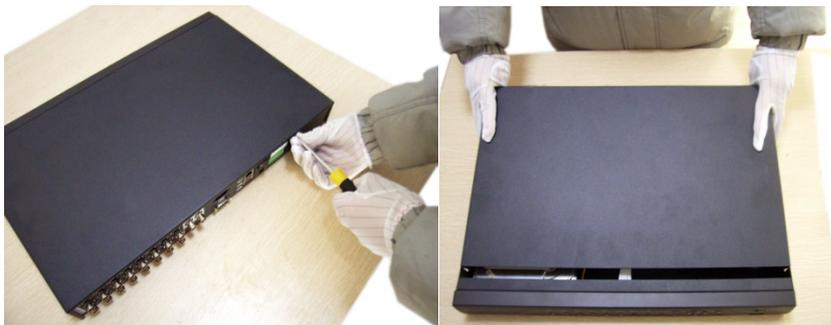
Открутите шурупы и снимите верхнюю крышку устройства
