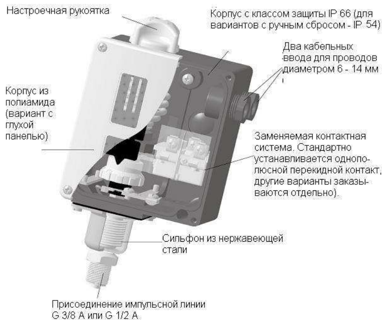
Рис.1. Устройство реле давления типа RT
