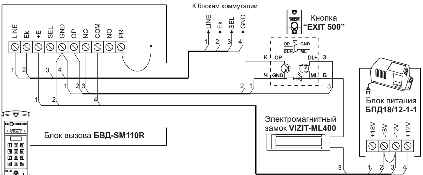
Рисунок 7 - Схема соединений блока вызова БВД-SM110R с электромагнитным замком VIZIT-ML400 , блоком питания БПД18/12-1-1 и кнопкой “EXIT 500”
