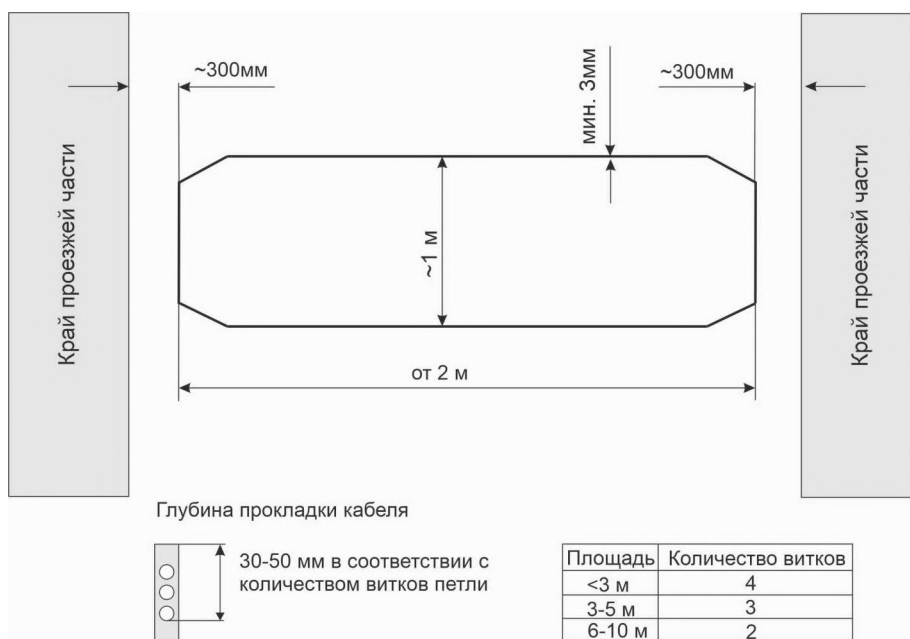
Рисунок 6.9.2.2 Схема монтажа петли
