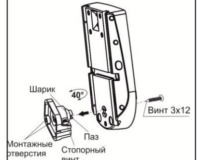
Провести провода от источника питания и шлейфа сигнализации через отверстие для ввода проводов в основании извещателя
