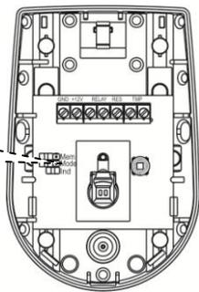
**11** Включить питание извещателя, при этом индикатор будет мигать **1 раз в 1 с** в течение не более 60 с – выход извещателя на рабочий режим
