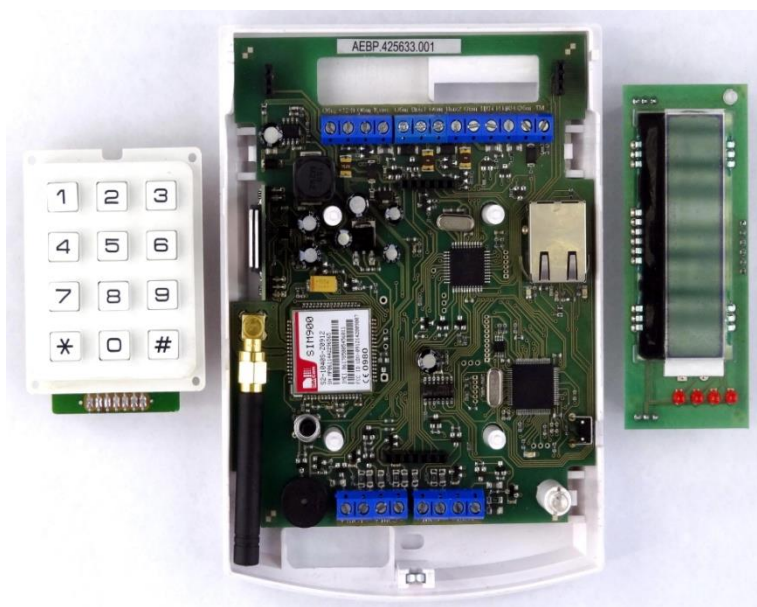
Рис. 1.4.2 Прибор со снятыми верхней крышкой, дисплеем и клавиатурой
