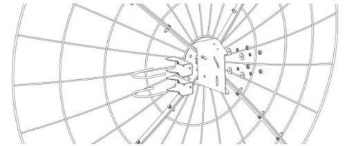
Шаг 4. Закрепите крепежную скобу и хомут для крепления антенны на мачте.
