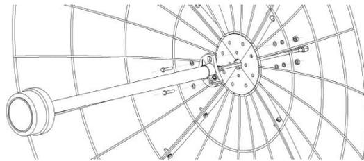
Шаг 2. Закрепите облучатель. Крепежное основание облучателя 24 дБ необходимо сдвинуть на 60 мм, как показано на чертеже. Ориентируйтесь по красным меткам на трубке облучателя для точного позиционирования крепежного основания.
