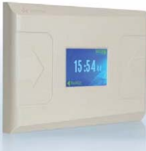
Рис. 1 Внешний вид контроллера регистрации PERCo-CR01 LICON
