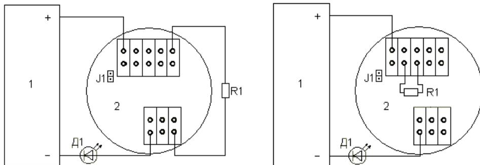
**1** – испытательный стенд с источником питания 8-28 В; **2** – извещатель; **R1** – ограничивающий резистор 1-2 кОм; **Д1** – контрольный светодиод; **J1** – переключатель вкл/откл фиксации при срабатывании.
