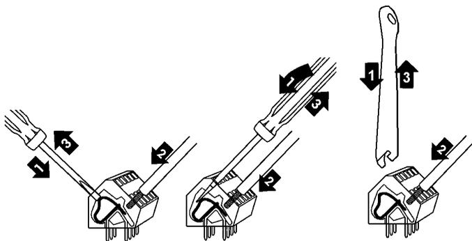
Для подключения проводников в клеммы:
