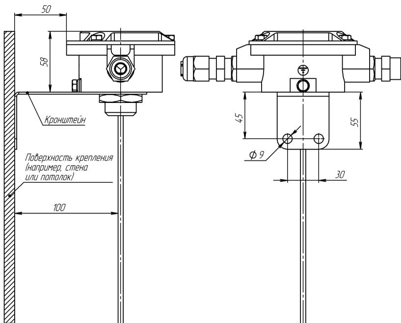
**Рисунок 3.** Пример крепления извещателя с помощью кронштейна КИПТ.
