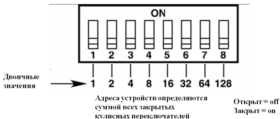
Рисунок 20 – Адресные переключатели извещателя
