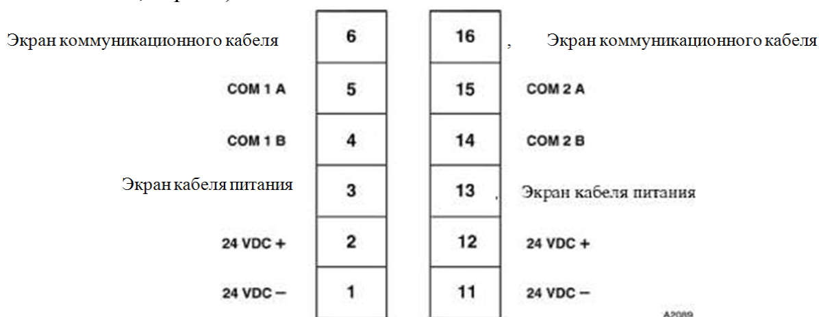
Рисунок 17 - Схема клеммных контактов адресной модели извещателя.
