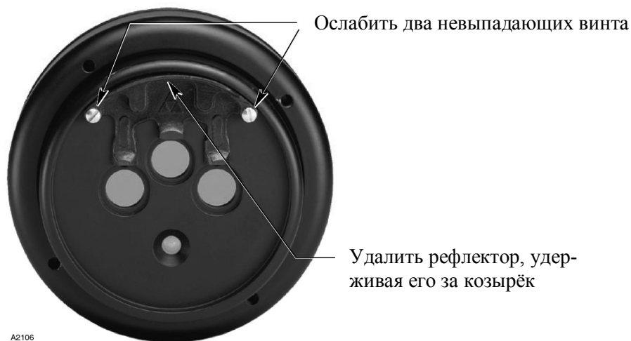
Рисунок 21 — Снятие рефлектора ОН.
