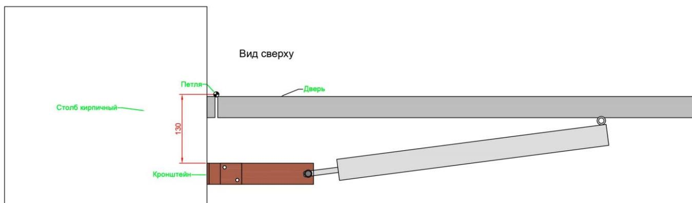
2. Закрепляем кронштейн при помощи саморезов, болтов, заклепок и т.д.
