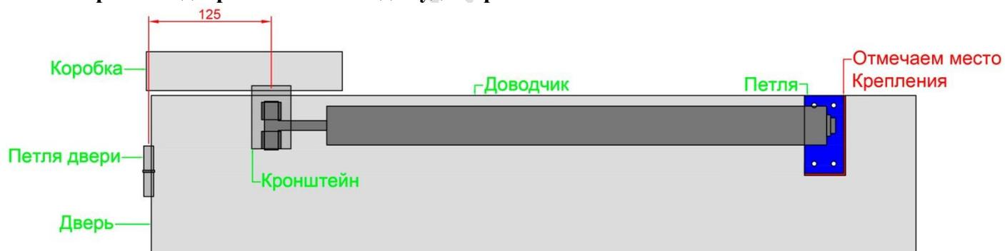
Снимаем доводчик, сдвигаем место крепления петли на 10 мм. к краю двери:
