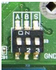
Рис. 7.1. Микровыключатели для выбора типа интеграции
