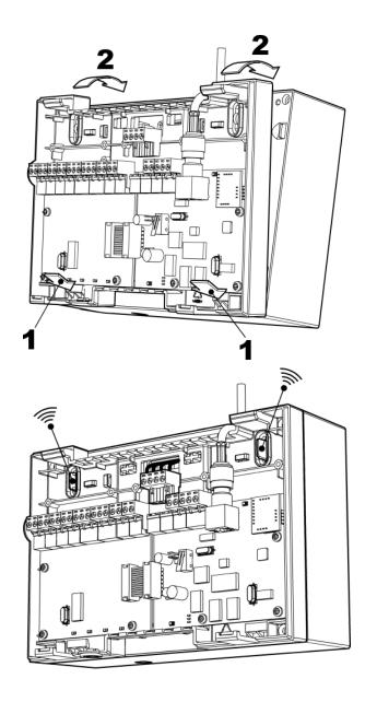
б) Соедините два паза 1 на приборе с выступами на БП и фиксируйте верхнюю часть 2 прибора до щелчка.
