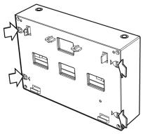
Для снятия панели несущей необходимо: отверткой (или пальцем) отжать две защелки по направлению от центра корпуса и потянуть панель на себя
