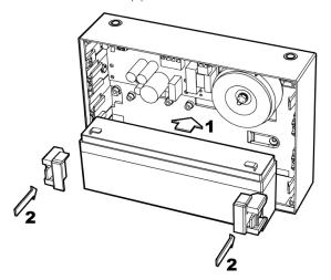
Установите в основание корпуса АКБ и зафиксируйте ее двумя держателями 2 (левым и правым).
