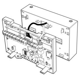
а) Через технологические отверстия выведите провода из БП и подключите их к прибору
