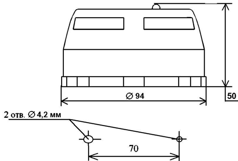
Рисунок 1 - Габаритные и установочные размеры извещателя
