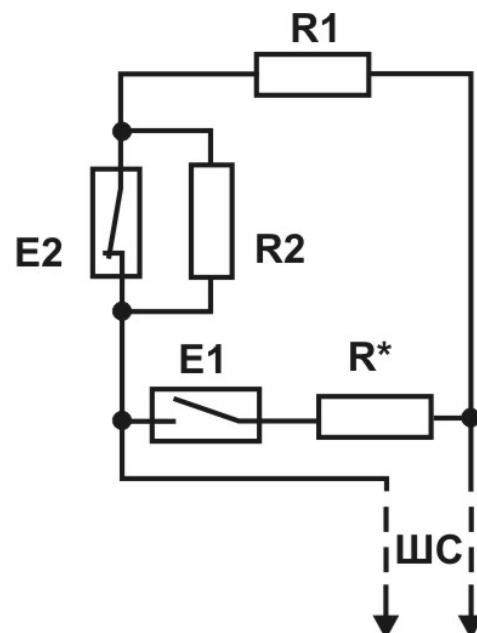
**Рисунок 3.** Схема подключения комбинированного пожарного шлейфа
