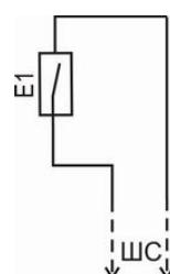
**Рисунок 4.** Схема подключения шлейфа контроля отметки патруля
